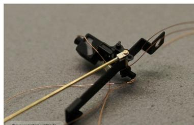
Die Gefahr dass Zinn zwischen Hebel und Stift fließt und damit das Gelenk blockiert ist wegen der Brünierung des hebels sehr gering,
