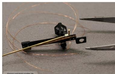
Den Stift am Kopf mit wenig Kleber oder einem Tropfen Lack sichern und Trocknen lassen.
