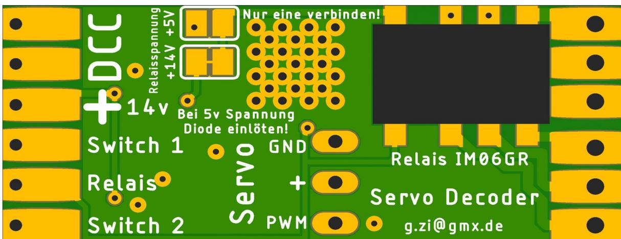
Auf der Unterseite sind die Decoderanschlüsse beschriftet
